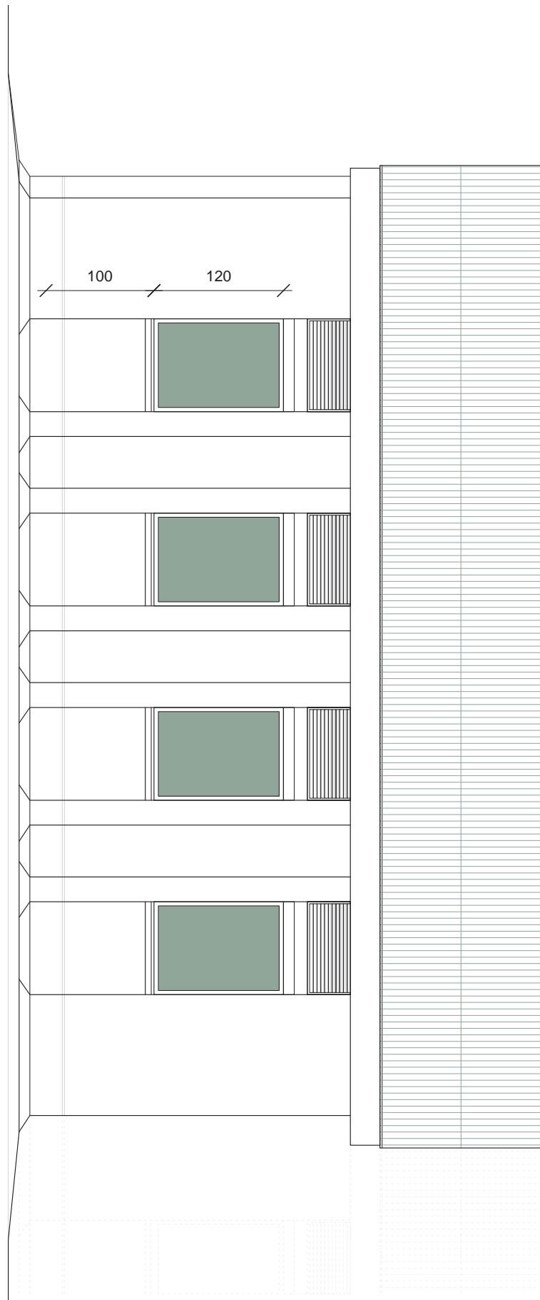
1 classe en RdC Mur porteur en briques cuites fin + contreforts Façade arrière - échelle 1/50
