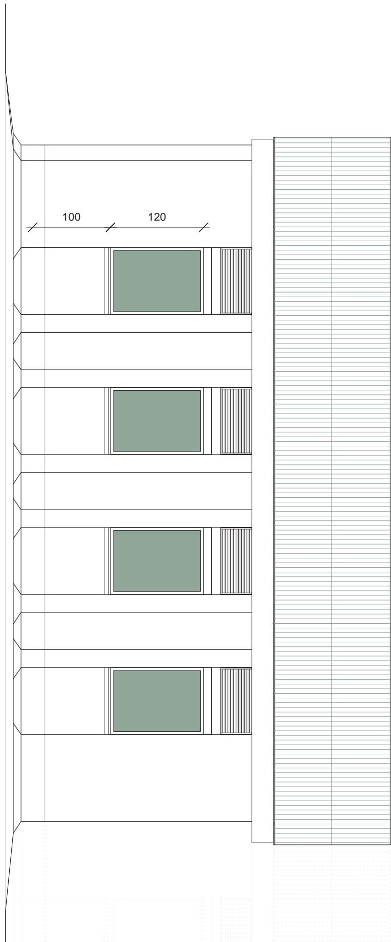
1 classe en RdC Mur porteur en adobe fin + contreforts Façade arrière - échelle 1/50
