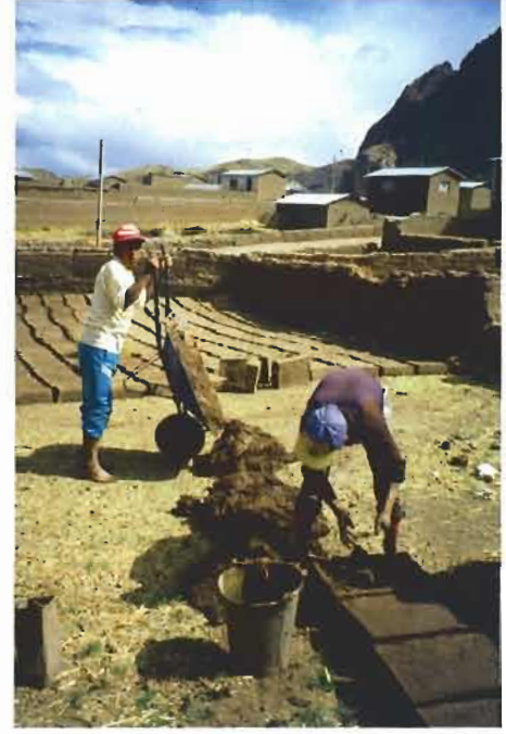
1. Village de Chincheros, près de Cuzco. 2. Chincheros. au premier plan : adobes séchant sur leur tranche. 3. Vue générale du travail d'équipe en famille. Derrière, on voit le village de Pucara, près de Puno à 3800 m d'altitude.
