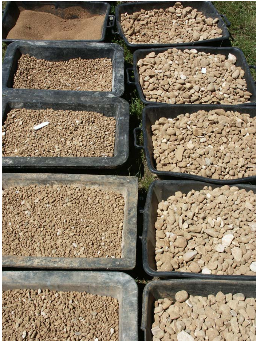
(Tri diamétral des cailloux après tamisage _ Grains d'Isère 2004)
