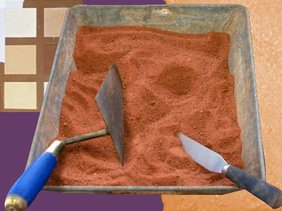
Les terres du Nord Isère conviennent très bien à la réalisation d'enduits stabilisés à la chaux
